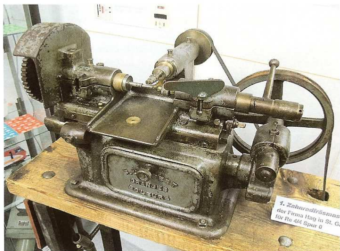
Von dieser Fräsmaschine stammt manches Zahnrad in Hag-Lokomotiven.
